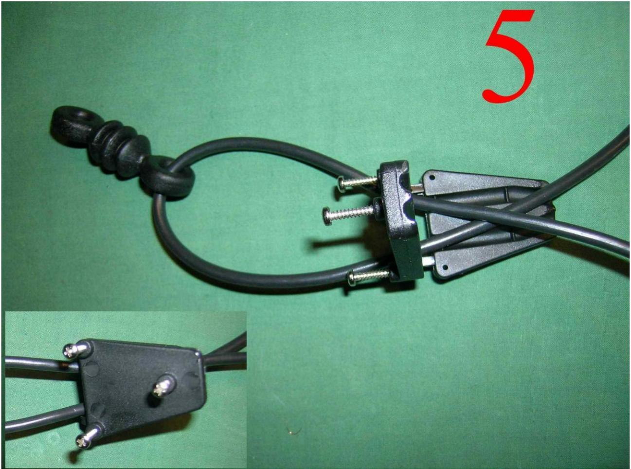
**Usando delle viti autofilettanti da 3 mm potrai un volta finita la taratura, chiudere definitivamente il morsetto.**
