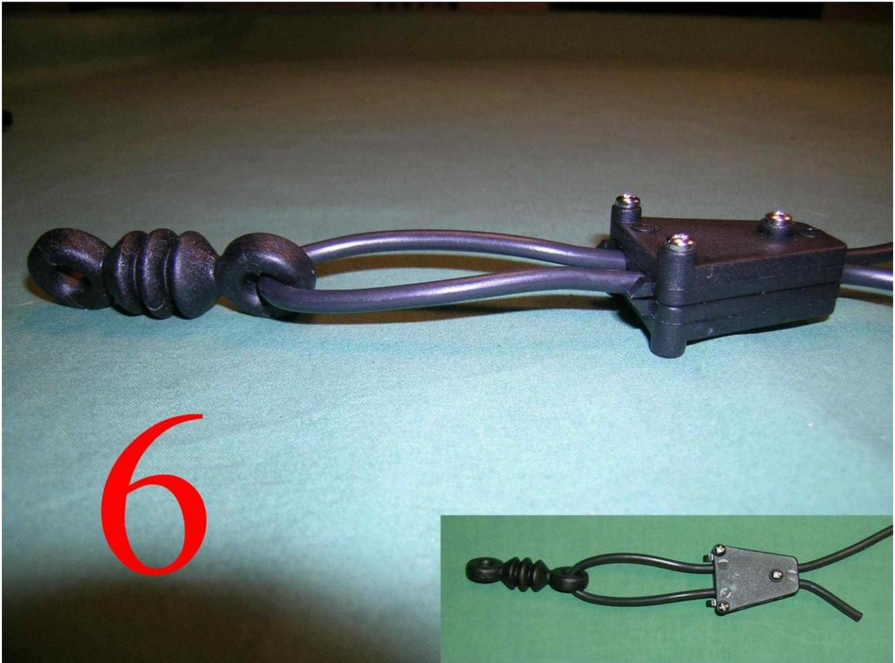
**Il tuo dipolo è ora pronto per essere montato, usa per, tendere gli isolatori, della cordina di nylon, tipo quella per stendere il bucato, non usare filo metallico perché potrebbe influire negativamente sulla taratura e sul funzionamento dell'antenna.**
