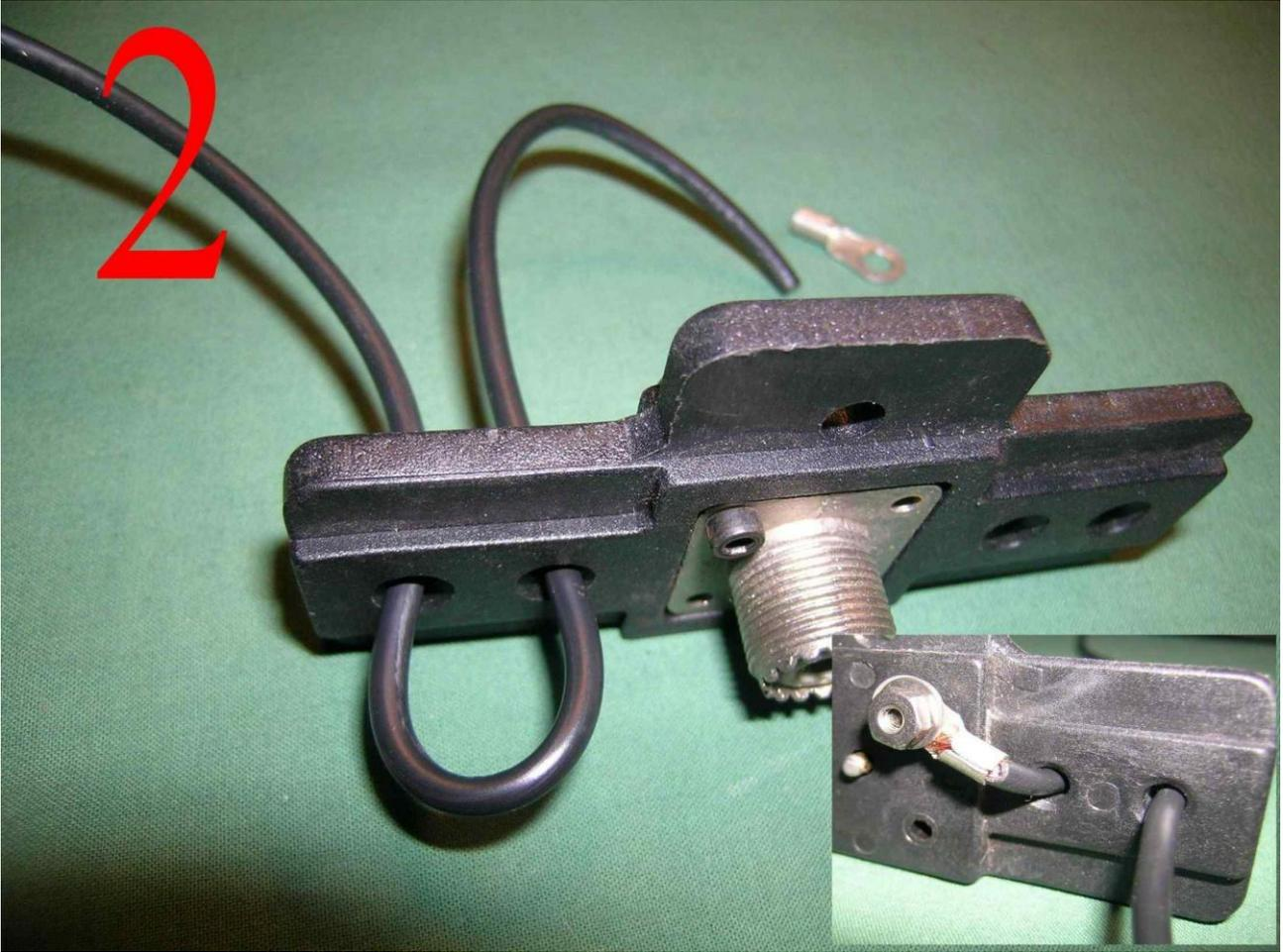
**Una volta passato il cavo, salda al cavo un capicorda che andrà serrato sotto uno dei dadi di fissaggio del connettore, questo sarà il “polo freddo”, la massa.**
